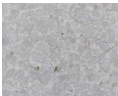
写真 9 鋼製の鍍 1度塗り
